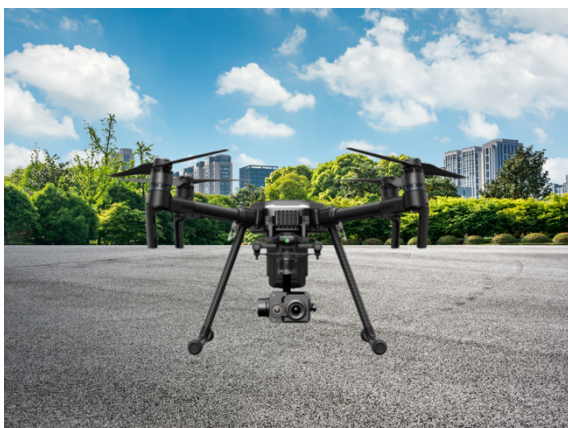
市販ドローン M200V2 + 赤外線カメラ XT2
